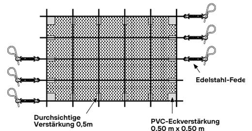
Eingenähte Gurte durchlaufend in der Breite und in der Länge
