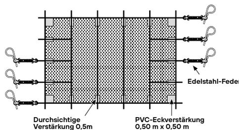
Eingenähte Gurte durchlaufend in der Breite und am Ende in der Länge
