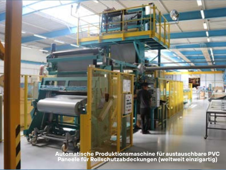
Automatische Produktionsmaschine für austauschbare PVC
