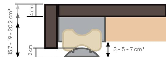
\* Höhenverstellbar mit 3 definierten Stufen
