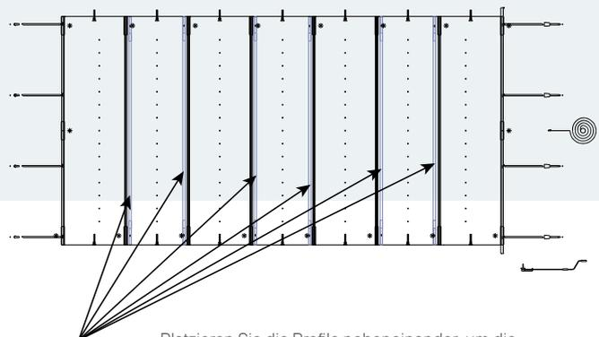
Platzieren Sie die Profile nebeneinander, um die Festigkeit der Abdeckung zu erhöhen und einen guten Abfluss des Regenwassers zu ermöglichen.
