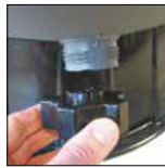
Entwässerungsrohr mit seinem Verschluss mit großen Abmessungen, das als Werkzeug zum Abbau dient
