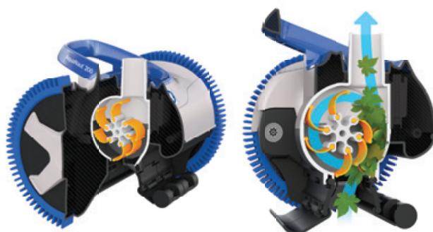
V-Flex®: Turbine mit mobilen Schaufelblättern, um große Schmutzteile einzufangen
