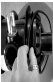
**5.** Legen Sie die Dichtung wie auf dem Bild über das Umschaltventil.
