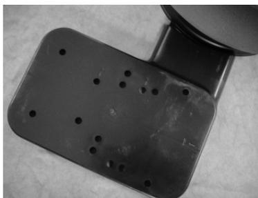
**1.** Grundplatte Pumpe montieren und Anlage richtig platzieren. Zuerst Grundplatte einrasten, bevor der Sand eingefüllt wird.
