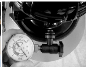
**8.** Schrauben Sie das Manometer ein. Achtung: nur von Hand und mit der dazugehörigen Dichtung. Man benötigt dafür kein Teflon.
