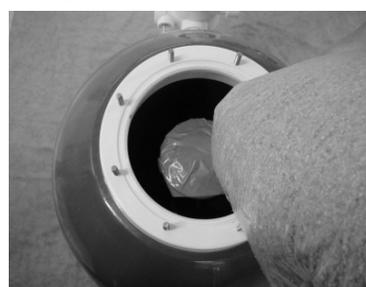
**3.** Füllen Sie zuerst den groben Sand/Glas und dann den feinen ein. Füllen Sie nur bis zu  $\frac{3}{4}$  auf und wässern Sie den Sand/Glas ein. Füllen Sie den Kessel mit Wasser.
