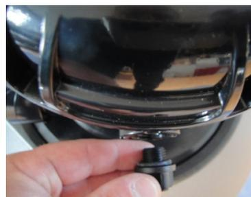
**7.** Nehmen Sie zuerst den Zapfen weg und anschliessend können Sie, wie Bild 8 zeigt, das Manometer montieren.
