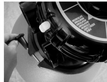
**6.** Setzen Sie das Umschaltventil auf den Filter. Spannen Sie nun den Klemmring darüber und ziehen Sie abwechselungsweise auf beiden Seiten gleich satt an. Klopfen Sie mit einem Gummihammer leicht auf den Spanningring und ziehen Sie weiter an.
