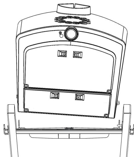
Mouvement 1 : Insérer le téton droit du four dans l'oreille percée
