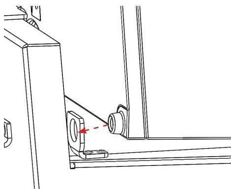
Mouvement 2 : Engager le four avec précaution dans l'oreille gauche ouverte
