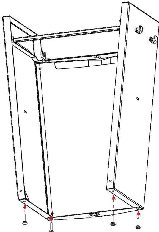
2 Positionner le braséro sous la structure et régler les pieds avant pour avoir 10 mm entre le dessus du braséro et le dessous de la barre transversale.
